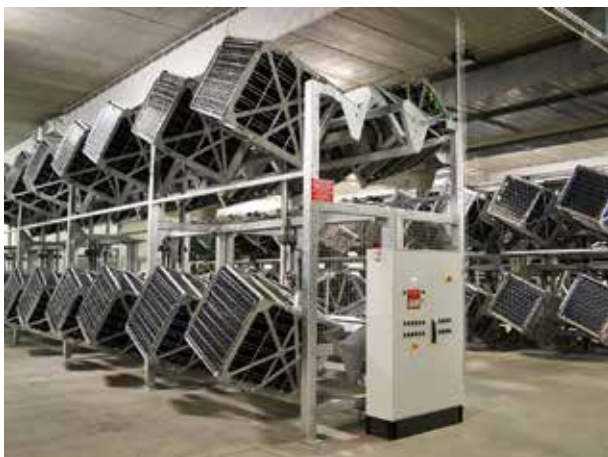
Les installations modernes de Mezzacorona composées de nombreux gropalettes permettent de réaliser le remuage en 7 jours
