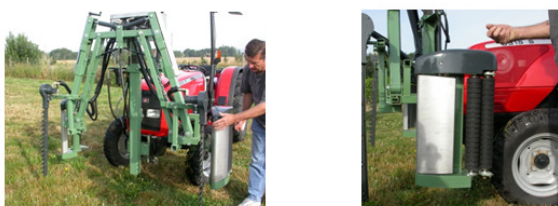
Effeilleuse Magnetto : rouleaux et barre de coupe
