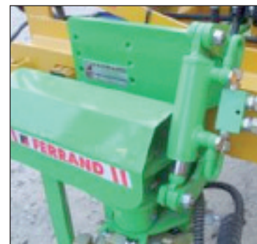
Vérin de contrôle du dévers Ferrand (Photo Ferrand).
