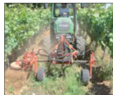
Montage à l'avant du Starmatic de Boisselet (Photo Boisselet).
