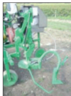
Dispositif Souslikoff d'assistance pneumatique et de régulation de la profondeur (Photo Souslikoff).
