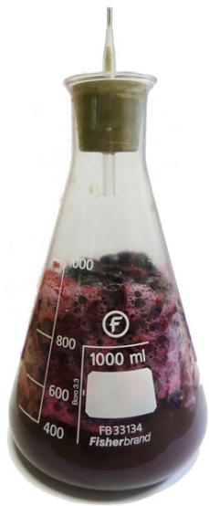
Photo 1 : La microvinification en erlenmeyer d'un litre est une technique fiable, répétable qui a largement fait ses preuves en œnologie
