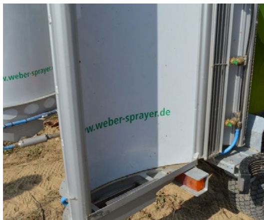
WEBER NC1000 UEZ QU : jet porté et buses à fente et à injection d'air
