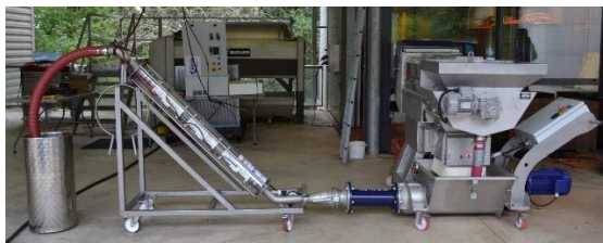
Figure N°4 : Pilote de traitement de la vendange par les CEP à 2 - 5 t/h
