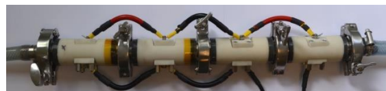
Figure N°4 : Quatre chambres de traitement du vin montées en série
