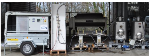
Figure N°7 : Démonstrateur de stabilisation microbienne des vins par des CEP (chambres de traitement + générateur) couplé à un échangeur de chaleur à plaques
