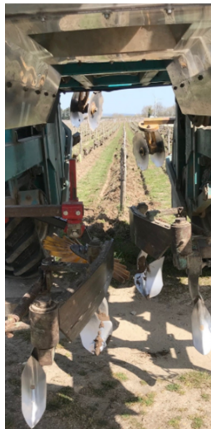
Figure 3 : outil de travail du cavillon (premier plan) déplaçant un volume de terre important (en arrière-plan)
