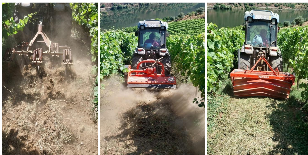
Figure 1. a) LABOURAGE - sol labouré, b) FAUCHAGE - végétation fauchée, c) ROULAGE - végétation roulée
